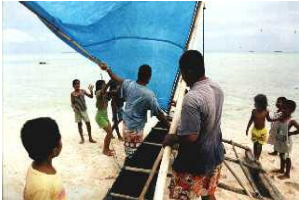
Zum Wenden muss der Mast des Auslegerbootes vom Bug zum Heck getragen werden
